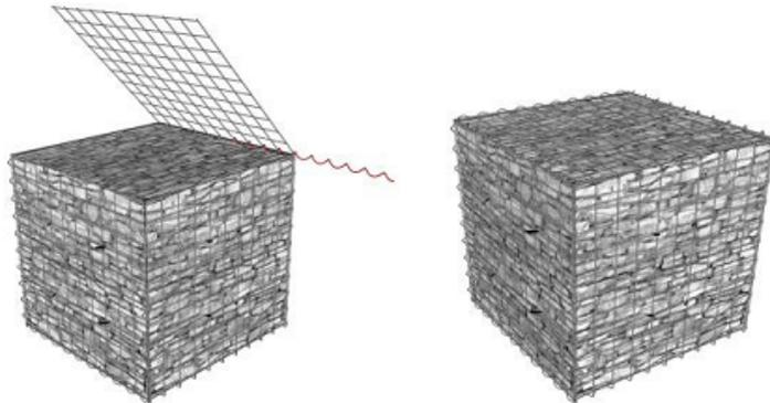
Bei zwei Korblagen übereinander tragen Sie eine Ausgleichsschicht von 2-3 cm aus feinkörnigem Material (z.B. 16/32 mm Korn) auf den geschlossenen Deckel der unteren Gabione auf. Vor dem Schließen müssen Sie schon die Seitenteile des oberen Korbes integrieren. Bringen Sie wieder, wie beim unteren Korb, die Distanzhalter an.
