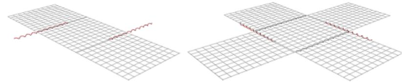
Anschließend werden die Seitengitter mit Spiralen verschlossen. Die Enden der Spiralen können zugebogen werden.
