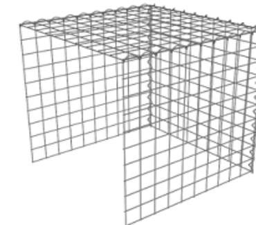
Wie im obigen Bild erkennbar, sind bei den Anschlusskörben B, C und D Gittereinsparungen vorhanden. Um diese mit dem jeweils vorhergehenden Korb zu verbinden, wird jeweils nur eine Spirale pro Berührungspunkt verwendet.
