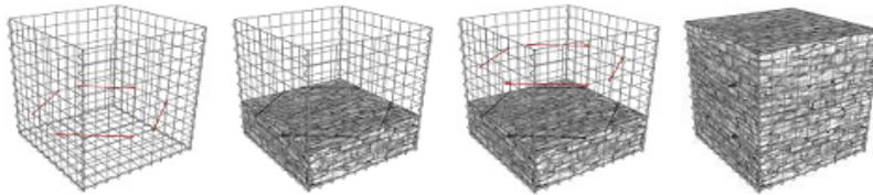
Verschließen Sie den unteren Korb, nachdem Sie ihn bündig befüllt (!) haben, mit einem passenden Gitter. Nehmen Sie als Verschluss wiederum Spiralen. Achten Sie dabei darauf, dass alle Gitter im Verbund verschlossen werden, d.h. alle aneinanderstoßenden Gitter werden mit einer Spirale verbunden (z. Bsp. 2 Körbe Verbau im Verbund à 3 Gitter, 1 Spirale).
