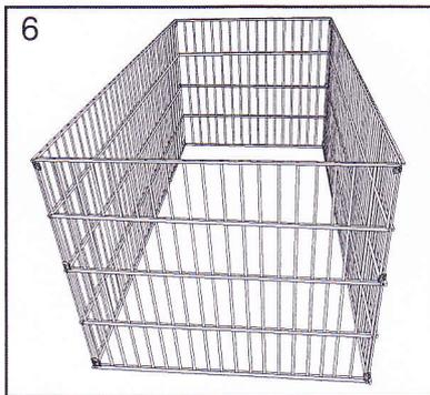
Befestigen Sie nun das zweite 100 cm Gittermatten-Innenelement im 90° Winkel mit 3 Universalklemmen am 230 cm Gittermatten-Innenelement (U-Form) und zuletzt das zweite 230 cm Gittermatten-Innenelement ebenfalls mit 3 Universalklemmen an beide 100 cm Gittermatten-Innenelemente (Rechteck).
