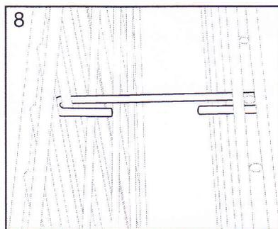
Hängen Sie nun die Abstandhalter (Grafik 3) gleichmäßig verteilt in die zwischen der äußeren und der inneren Gittermatte ein. An der langen Seite, je nach Variante (60/80) je 7 bzw. 9 Stück. An der kurzen Seite, je nach Variante (60/80) je 4 bzw. 5 Stück.
